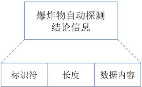
图 9 爆炸物自动探测结论信息组成
