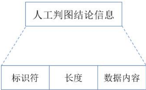
图 11 人工判图结论信息组成
